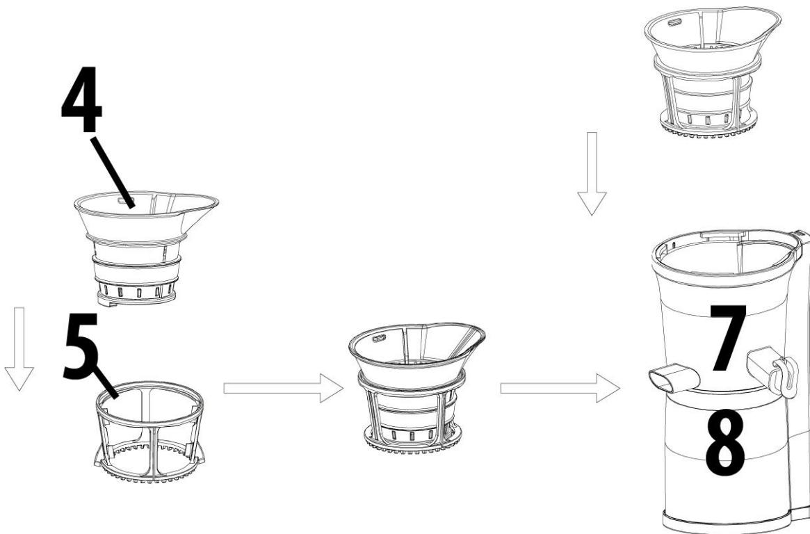
**Per l'estrazione di succo:** Infilare il vaglio per succo (4) nel cesto porta-raschiatore (5) e ruotarlo leggermente finché il cesto scatta in posizione.
