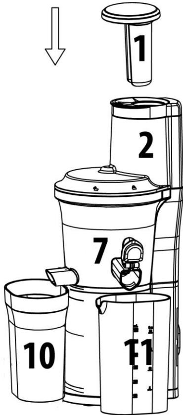
Placer le poussoir (1) dans le couvercle avec la tube d'alimentation (2).
