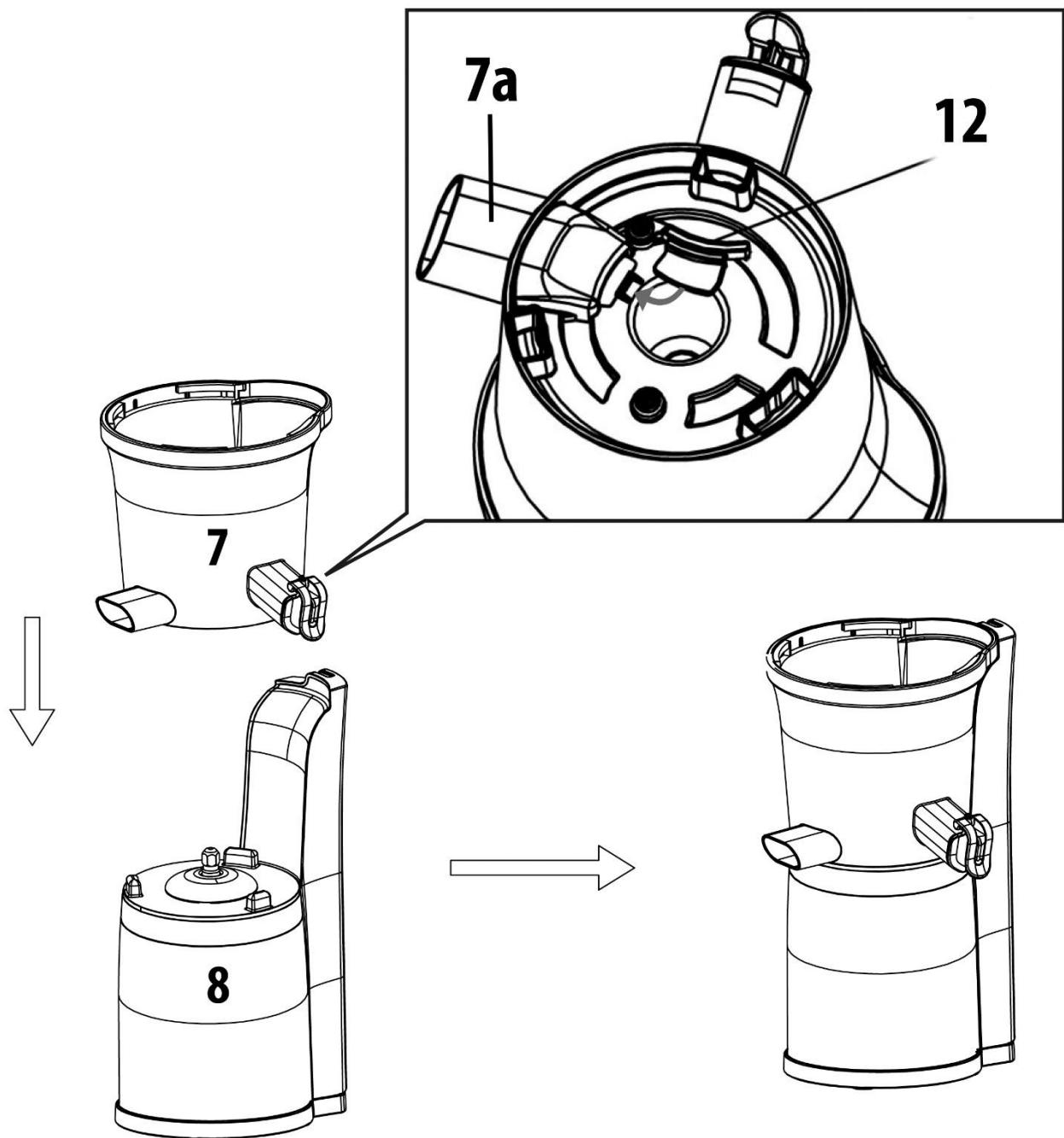
Kontrollera att silikonkontakten (12) är placerad i utloppet för fruktköttet (7a), se undersidan av mittsektionen med utlopp (7).
