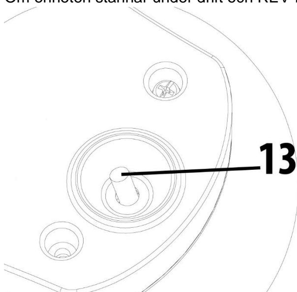
Ställ strömbrytaren i läge OFF för att stänga av anordningen. Tryck sedan på återställningsknappen (13) på undersidan av anordningen. Tryck anordningen försiktigt en bit över bordskanten, så att ni bara kan nå återställningsknappen.
