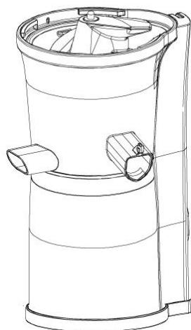
A continuación, coloque el sifón de prensado (3) en el filtro de zumo/inserto para sorbete colocado, presionar y girar hasta que quede enclavado.
