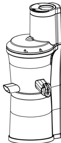
Colocar la ranura de carga (2) de forma que el símbolo de la ranura de carga quede colocado en el centro (7) sobre el símbolo . Presionar hacia abajo y girar a derechas, hasta que el símbolo de la ranura de carga (2) quede colocado en el centro (7) sobre el símbolo .
