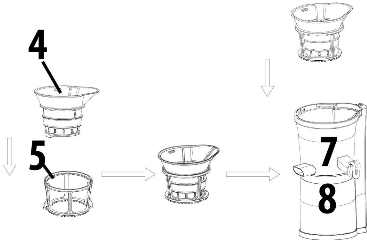
**Für das Entsaften:** Saftsieb (4) in Wischerkorb (5) stecken und leicht drehen, bis der Wischerkorb einrastet.
