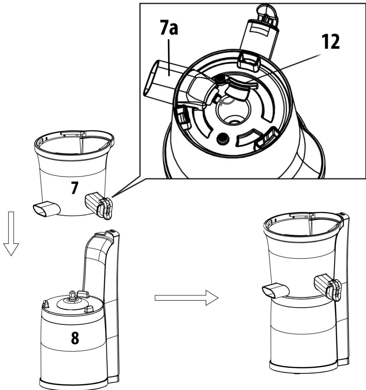
Verificare che il tappo in silicone (12) sia inserito nell'uscita di residui (7a), vedi in basso la parte centrale con uscite (7).
