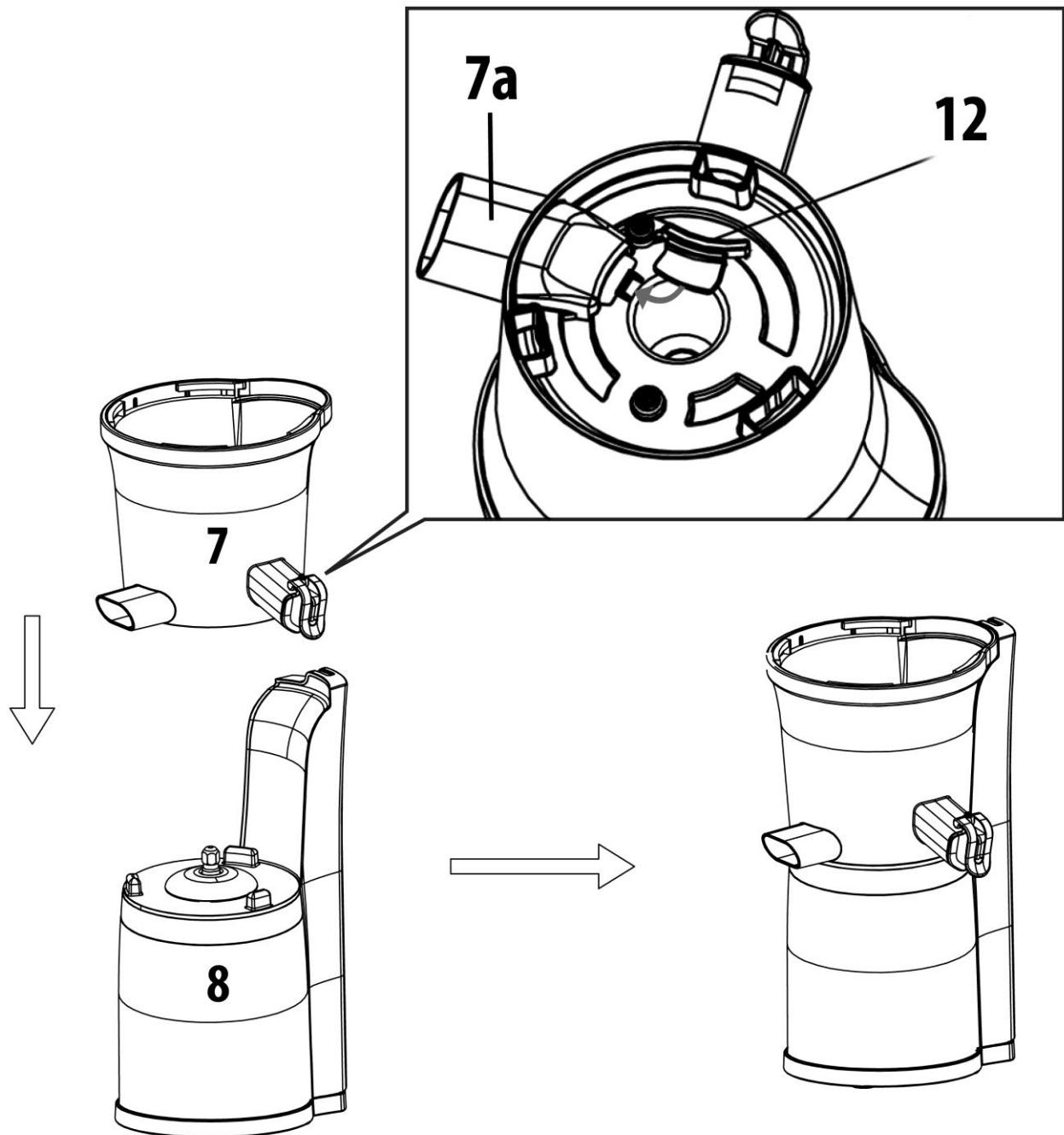
Prüfen Sie, dass der Silikonpropfen (12) im Auslauf für den Trester (7a) platziert ist, siehe Unterseite Mittelteil mit Ausläufen (7).
