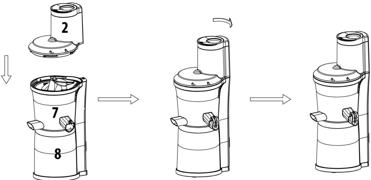
Posizionare il vano di riempimento (2) in modo tale che il simbolo sopra il vano di riempimento sia posizionato sopra il simbolo della parte centrale (7). Premere in basso e ruotare in senso orario, finché il simbolo sopra il vano di riempimento (2) sia posizionato sopra il simbolo della parte centrale (7).
