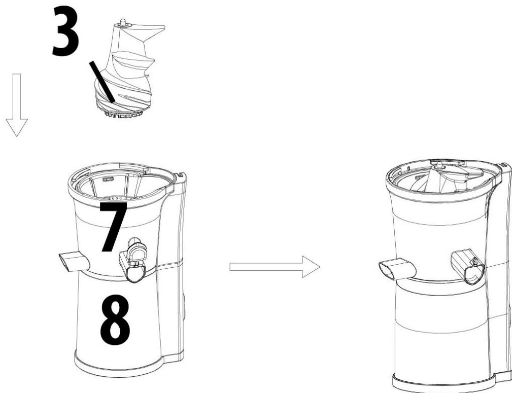
Dann die Pressschnecke (3) im bereits eingebauten Saftsieb / Sorbeteinsatz platzieren, herab drücken und drehen bis diese einrastet.
