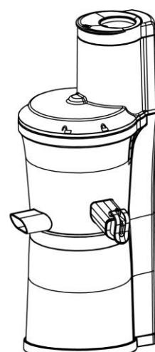
Placer la tube d'alimentation (2) de manière à ce que le symbole sur la tube d'alimentation soit placé au-dessus du symbole sur la partie centrale (7). Pousser vers le bas et tournez dans le sens des aiguilles d'une montre jusqu'à ce que le symbole sur la tube d'alimentation (2) est placé au-dessus du symbole sur la section centrale (7).
